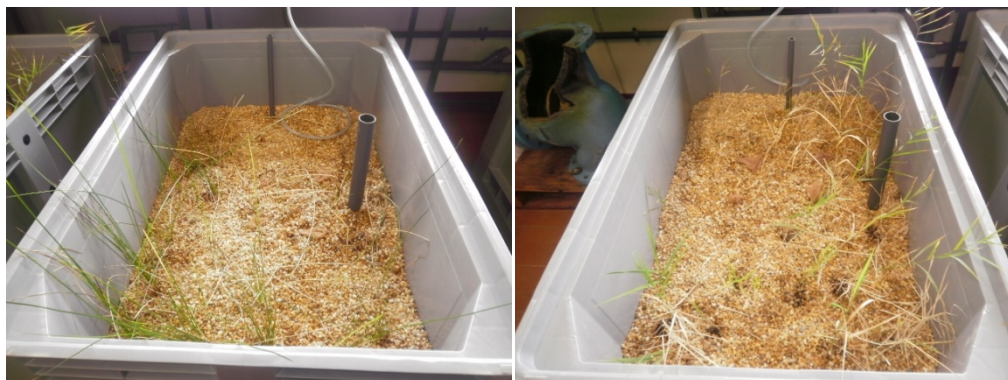
Figura 4.5 - Instalação experimental de leitos de macrófitas. Fotografias da vegetação plantada. Senescência das espécies presentes nos leitos L5 plantado com Scirpus holoschoenus (esquerda) e L3 plantado com Phragmites australis (direita), respectivamente.
