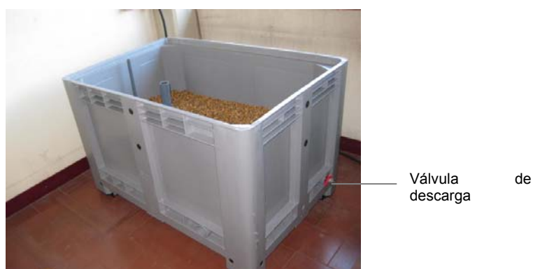
Figura 4.3 - Instalação experimental de leitos de macrófitas. Aspecto geral de um leito de macrófitas.
