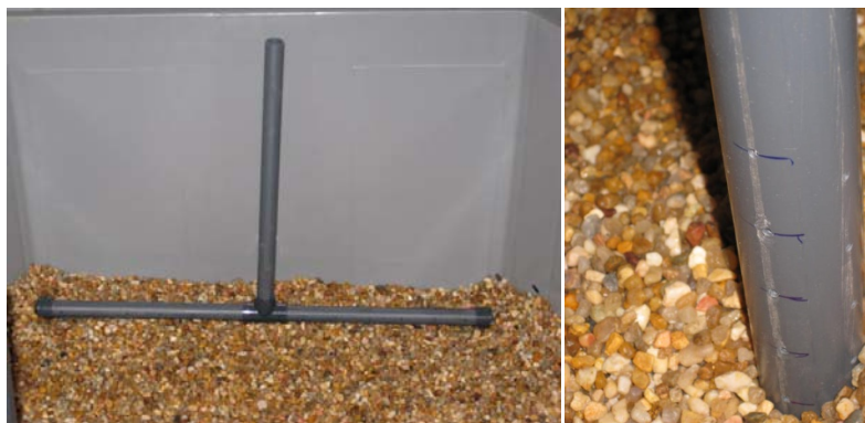
Figura 4.2 – Instalação experimental de leitos de macrófitas. Tubagem de alimentação perfurada, localizada a meia altura do enchimento, à esquerda. Tubo perfurado colocado no meio do leito, à direita.
